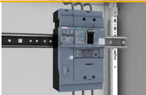
Interruttore scatola 3VA1, 160 A, con sganciatore magnetotermico di sovracorrente e modulo differenziale collegato lateralmente – installato in un quadro elettrico di distribuzione.
